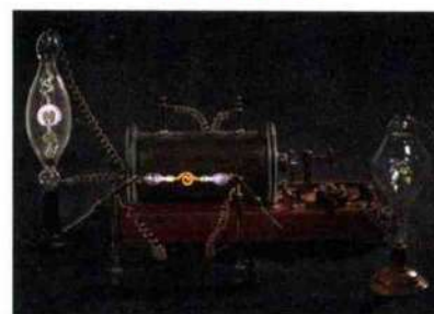
Trois tubes de Geissler, ancêtre du néon, sur pied de bois, connectés à une bobine de Ruhmkorff.
